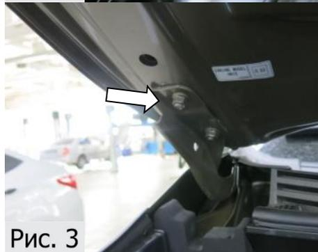
3. Открутить верхнюю гайку крепления капота торцевой головкой №12,(Рис. 3).
