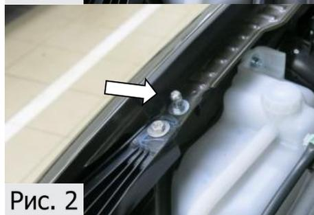
2. Установить болт-шарнир с шайбой 6. Затянуть болт-шарнир удлиненной торцевой головкой №10 с усилием 9 Нм, (Рис.2).
