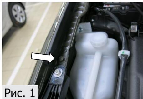
1. Открутить штатный болты крепления крыла торцевой головкой №10 (Рис.1).
