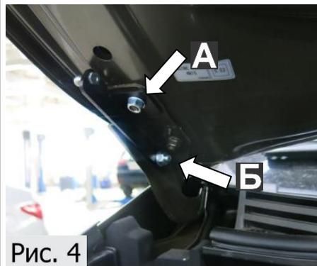
4. Установить кронштейн, как показано на рисунке 4. Затянуть штатную гайку (А) торцевой головкой №12 с усилием 23 Нм. Дополнительно закрепить кронштейн к петле капота болтом М8х20 и гайкой М8 с двумя шайбами 8 (Б). Используя торцевую головку №13 и рожковый ключ №13 затянуть данное резьбовое соединение с усилием 23 Нм.
